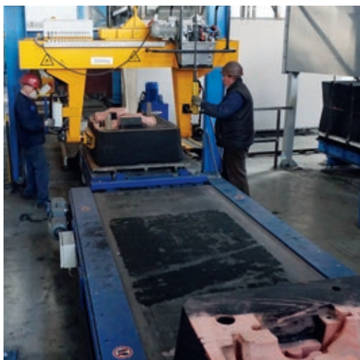
合箱 Składanie i kłamrowanie formy
