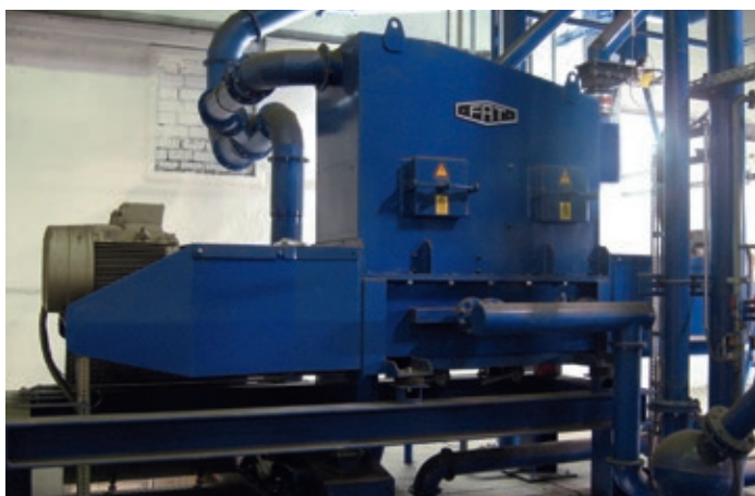
摩擦破碎再生机：旧砂的机械再生 Combicleaner – dynamiczny układ doczyszczania mechanicznego regeneratu
