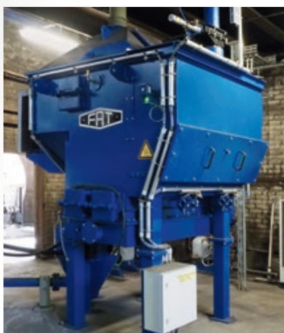
沸腾砂温冷却床 Chłodziarko-fluidyzator (chłodzenie i odpylanie w złożu fluidalnym)
