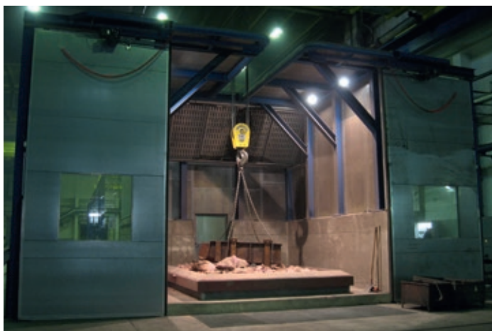
带有落砂室的落砂栅格 Krata wstrząsowa z kabiną dźwiękochłonną
