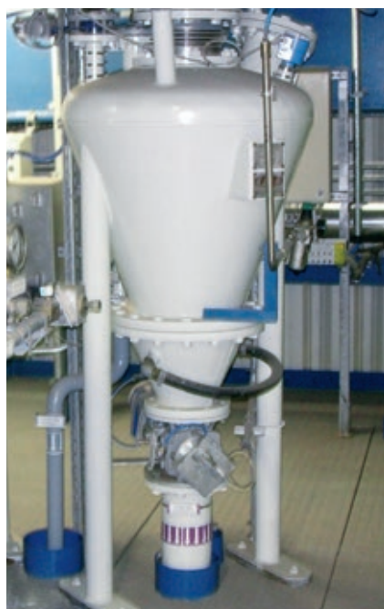
连续气力输送装置 Instalacja ciągłego wdmuchiwania
