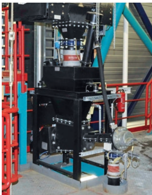
重量给料系统 Grawimetryczne dozowanie
