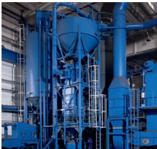
热砂砂斗及砂温冷却装置 Silos gorącej, wybitej masy i chłodnica spiętrzająca
