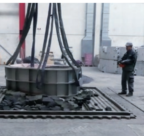
无落砂室设计的落砂栅格 Krata wstrząsowa bez kabiny dźwiękochłonnej
