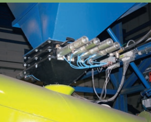
定量阀-用来控制不同型砂的配比比例 Dozownik piasku (nawet kilku typów) dla zestawiania i podawania różnych proporcji piasku
