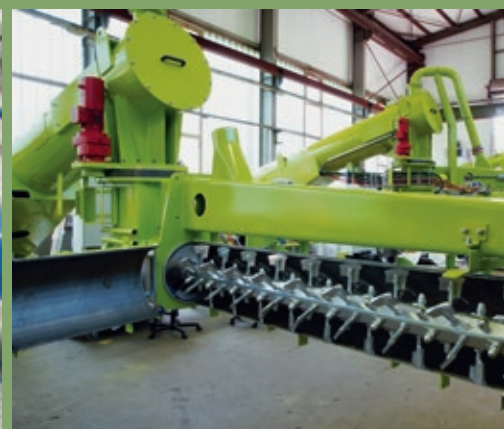
混砂臂及叶片 Wał mieszalnika mieszarko-nasypywarki z łopatkami mieszającymi
