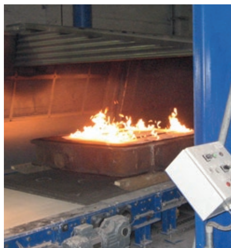
醇基涂料点火 Wypalanie pokrycia
