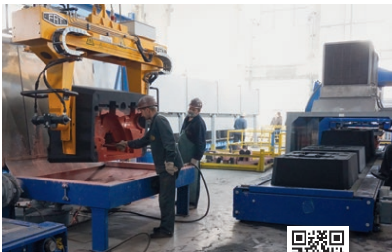
砂型表面涂料 Nanoszenie pokrcia na wnękę formy
