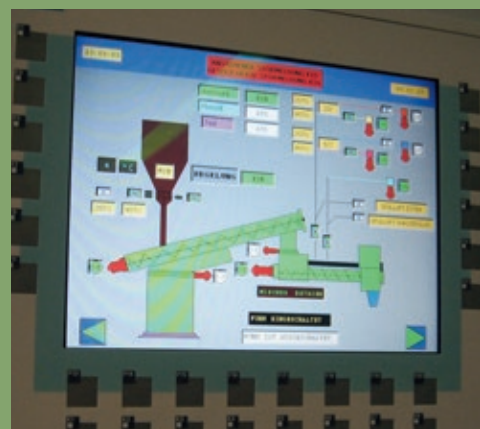
彩色控制面板 Kolorowy panel sterowania/ obsługi mieszarko-nasypywarki
