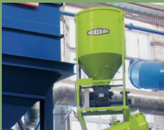
型砂添加剂定量给料装置 Urządzenie podające specjalne dodatki do masy formierskiej
